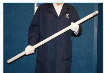
**1984** Einführung der UVB-313-Lampen. Diese Entwicklung von Q-Lab ist die erste Lampe, die speziell für ein Bewitterungsgerät mit UV-Leuchtstofflampen konzipiert wurde. Der wesentliche technische Vorzug gegenüber vorherigen UVB-Lampen liegt darin, dass sie eine höhere Strahlungsstärke erzeugt und eine längere Lampenlebensdauer bietet.
