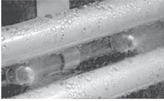
**1989** Einführung der QUV Besprühungs option zur Ergänzung des Betaungssystems des QUV. Besprühung erzeugt eine mechanische Erosion an Holzanstrichen und Thermoschocks an Kunststoffen. Der Entwurf basiert auf der Arbeit der EMPA (Eidgenössische Materialprüfungs- und Forschungsanstalt).
