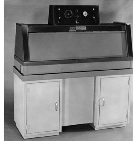
**1970** Einführung des QUV Schnellbewitterungsgeräts. Dieser revolutionäre Entwurf von Q-Lab kombiniert Kondensation und UV-Leuchtstofflampen. Er setzt neue Maßstäbe in Bezug auf Einfachheit, Geschwindigkeit und Bedienerfreundlichkeit. Die eingesetzten UVB-Lampen wurden ursprünglich für die Vitamin-D-Synthese entwickelt.
