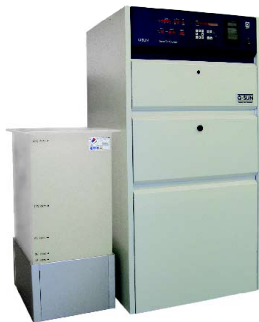
Q-Sun Xe-3-HDS 可向样品喷淋水和其它溶液。
