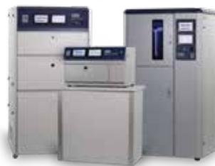
Nos enceintes Q-SUN sont des enceintes à Arc Xénon qui reproduisent la totalité du spectre solaire. Elles permettent de tester la résistance à la lumière d'un matériau, la tenue des couleurs et la photostabilité d'une formulation.
