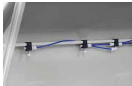
顶部摇摆喷淋杆
