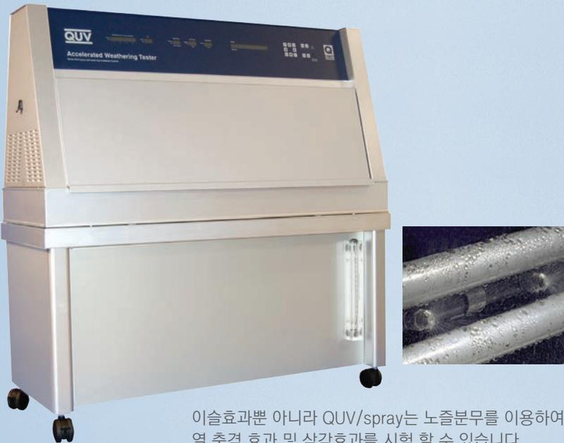
이슬효과뿐 아니라 QUV/spray는 노즐분무를 이용하여 열 충격 효과 및 삭각효과를 시험 할 수 있습니다.
