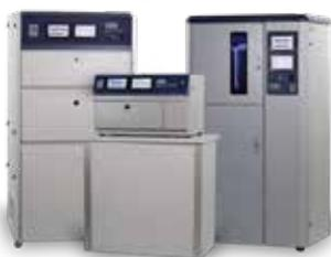
Q-SUN strumenti di prova ad arco di Xenon sono dotati di tutti i dispositivi per eseguire test di resistenza alla luce, solidità del colore e fotostabilità. Queste camere riproducono i danni causati dallo spettro completo della luce solare e dalla pioggia. Le lampade allo xeno offrono la migliore riproduzione dello spettro completo della luce solare. Filtri ottici utilizzati in condizioni standard hanno durata indefinita.
