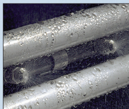
QUV/Sprayは結露に加え、スプレー機能によって熱変化ショックと表面侵食を再現します。
