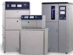
As câmaras de teste de arco de Xenon Q-SUN são cheias de recursos para testar as propriedades da cor, da fotoestabilidade e reproduzir os danos causados pelo espectro total da luz solar e da chuva. As lâmpadas de Xenon proporcionam a melhor semelhança com o espectro total de luz solar. Sob as condições normais de uso, os filtros ópticos das câmaras duram indefinidamente.
