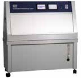
자연상태에서의 현상을 재현하기 위해서, QUV 촉진내후성 시험기는 UV 자외선 광원과 수분 그리고 온도가 조합된 복합사이클을 구성하여 시험을 진행합니다. UV 자외선 램프를 이용하여 태양광 노출을 재현하고, QUV의 특별한 기능인 Condensation Step(이슬효과)와 스프레이 시스템을 이용하여 자연상태의 강우와 이슬에 의한 물질에 대한 손상시험이 가능합니다. 광량에 대한 세기와 빛의 스펙트럼에 대한 캘리브레이션은 사용자가 몇 분 안에 손쉽게 할 수 있게 되어있으며, 장비의 설치부터 사용 그리고 유지보수에 이르기까지 매우 편리하게 디자인되어 있습니다. 전세계적으로 누적 판매량으로는 단대가 넘는 실적을 보이고 있습니다. 그에 따라 "QUV"라는 상표 그 자체가 UV촉진 내후성시험의 국제표준 장비로 고유명사화 되어 있습니다.
