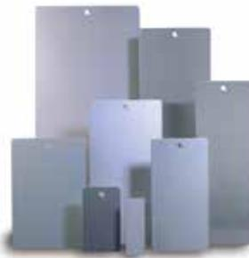
반세기를 넘어 60년이 가까운 기간 내내 Q-PANEL Steel 및 Aluminum 표준시편은 도료, 접착제, 실런트 등이 사용되는 코팅업계에서 세계적인 표준 시편으로써 자리매김 해 왔습니다. Q-PANEL Steel 및 Aluminum 표준시편은 언제나 안정된 일관성 있는 품질로 아주 예민한 페인트, 도막 및 접착제 등의 시험에서 유용하게 사용되고 있습니다. 세계 각국의 수많은 연구소에서 칼라개발, 내광/내후성 시험, 부식시험, 물성시험 및 품질관리를 위해 한 해 동안 수백만 개의 Q-PANEL 시편을 사용하고 있습니다.
