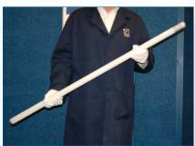
**1984**年 研究开发了UVB-313 灯管。这种灯管是Q-Lab专门为荧光 老化试验机设计的。与之前的UVB 灯管相比有了重大技术进步,可提供更高辐照度和更长灯管寿命。
