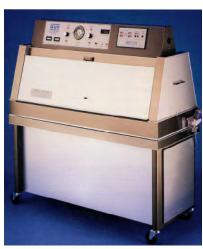
**1994** Q-Lab 开发了专用嵌入式微处理控制器,这种控制器首次用于老化试验机。它取代了不连续的机电控制方式。这种新的控制器控制更好、操作更简单,并显示故障错误信息。
