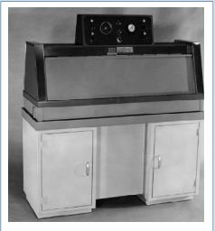
1970年 QUV 加速老化试验机问世。Q-Lab 这一革命性的设计把冷凝测试和紫外光照结合起来,开创了简单、快速和易于操作的测试新标杆。UVB 灯管最初用于维生素 D的合成。
