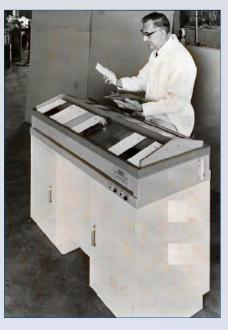
**1965**年 Q-Lab 公司发明 QCT"克利夫兰冷凝试验机"。它是 QUV的前身,只提供冷凝测试功能,没有紫外光照功能。
