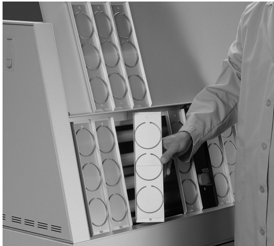
Das QUV besitzt die fünffache Kapazität des Q-SUN Xe-1 und die 1,5-fache Kapazität des Xe-3.
