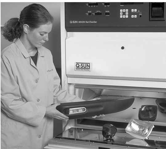
Das Q-SUN Xe-3 ermöglicht die Befestigung von 3-D-Teilen, Reagenzröhrchen und Petrischalen sowie von flachen Platten.
