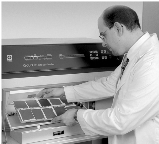
Das Q-SUN Xe-1 ermöglicht eine vielseitige Probenmontage, einschließlich 3-D-Teile und flachen Prüflingen.
