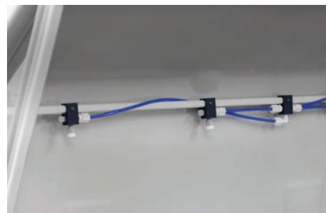
顶部摇摆喷淋杆
