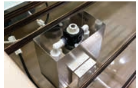
Buse de brouillard
