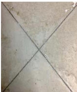
Die auf die blanke Aluminiumoberfläche aufgetragene Farbe ist vollständig delaminiert
